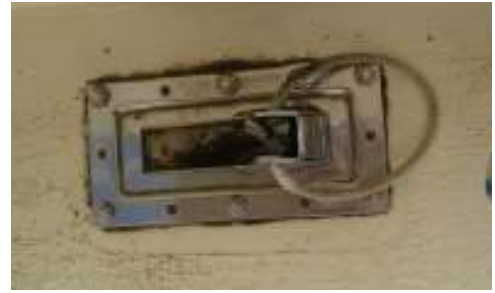
Écopeur automatique : il se retrouve souvent sur le plancher de la coque des petits dériveurs.
