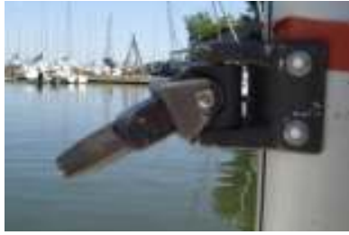
Le vit de mulet : la bôme se glisse dans le vit de mulet afin de se fixer au mât.
